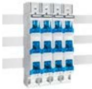
**Sezionatore verticale per fusibili NH 1 - 3**, sez. contemporaneamente, per montaggio su barre forate, vite M12
