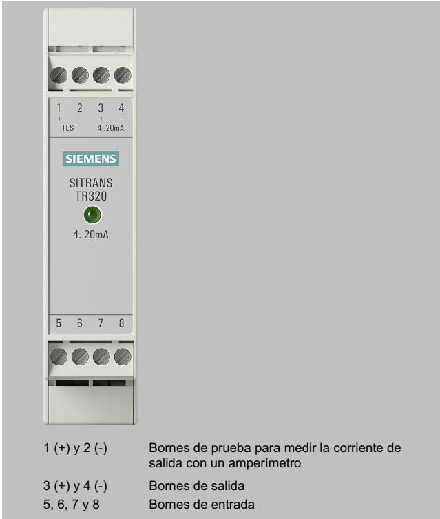
SITRANS TR320, asignación de conexiones
