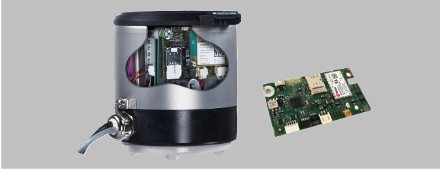
IloT Wireless Communication Module (drahtloses Kommunikationsmodul)
