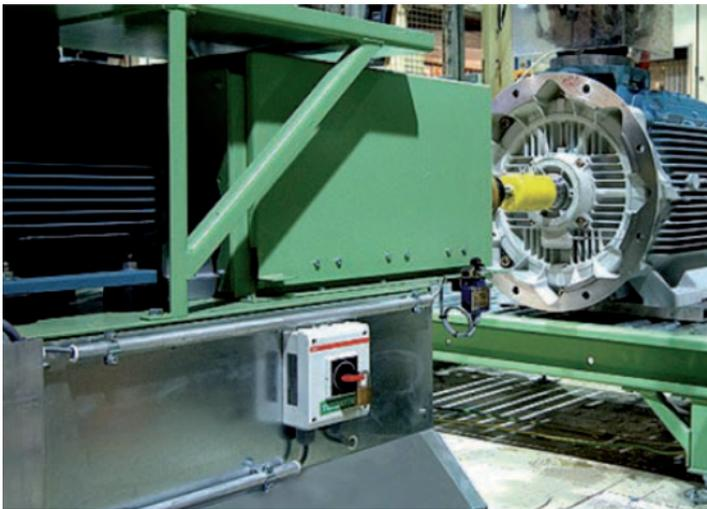
Los Seccionadores de Seguridad pueden ser bloqueados por cándado en la posición OFF.
