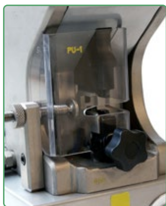
PNB-1 particolare della zona compressione con protezione PU-1.
