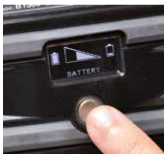
Nuovo Display OLED multifunzione con tasto capacitivo a sfioramento
