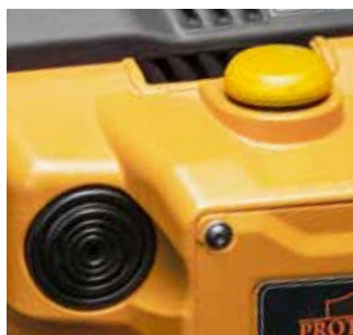
Indicateurs LED et buzzer
