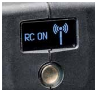
Multifunktionales OLED-Display mit Touch-Taste
