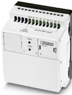
12 V DC, 8 entradas digitales, 2 entradas analógicas y 4 salidas de relé
