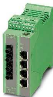
4 puertos RJ45 y 2 puertos de fibra óptica en formato ST (multimodo)
