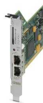
Enrutador con cortafuegos para PCI
