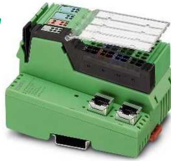
Conexión de cobre de 2 puertos, 8 entradas digitales y 4 salidas digitales
