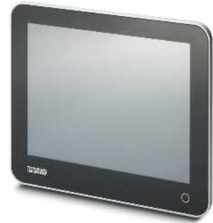
Panel PC en IP65, Pantalla de 37,8 cm (15")
