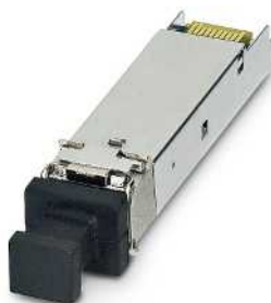
Módulos SFP para alcances de transmisión de hasta 80 km
