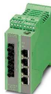
4 puertos RJ45 y 2 puertos de fibra óptica en formato ST (unimodo)
