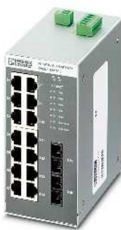
14 puertos RJ45 y 2 puertos de fibra óptica
