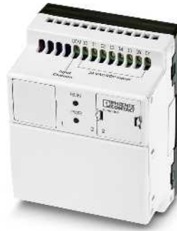
24 V DC, 8 entradas digitales, 2 entradas analógicas y 4 salidas digitales PNP
