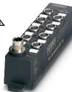
4 entradas digitales y 4 salidas digitales
