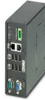
Box-PC con amplio intervalo de temperatura
