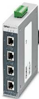
4 puertos RJ45 y 1 puerto de fibra óptica
