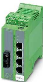
4 puertos RJ45 y 1 puerto de fibra óptica (multimodo)
