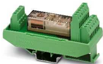
Relé de acoplamiento guiado, 4 contactos abiertos, 2 contactos cerrados
