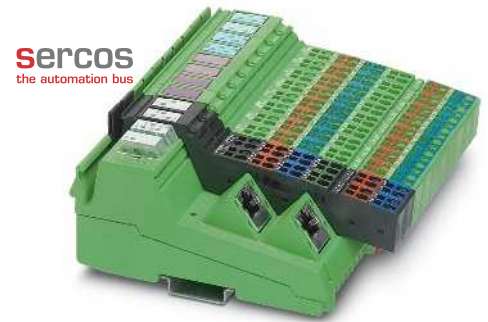
16 entradas y 16 canales seleccionables (entrada o salida)
