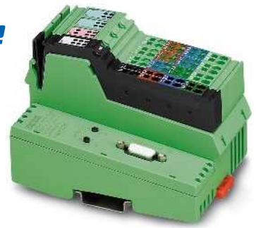
Conexión SUB-D, 8 entradas digitales y 4 salidas digitales
