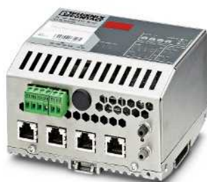
Proxy de fibra óptica PROFINET-INTERBUS
