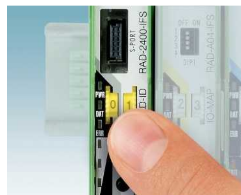
Direccionamiento fácil: con un giro de la rueda selectora de la estación de radio
