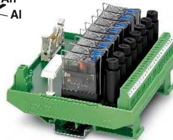
Módulo de salidas con 8 relés miniatura, 1 contacto conmutado con accionamiento manual fijable y fusible por circuito de salida
