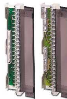
Adaptador frontal para MODICON TSX Quantum
