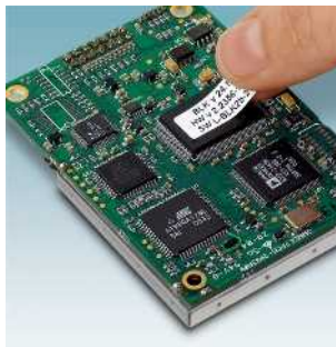
Marcado de aparatos para adherir, se puede despegar, para rotulación con THERMOMARK ROLL... EML-RM... Pág. 286
