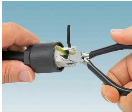
2. Cortar al ras el extremo del hilo trenzado
