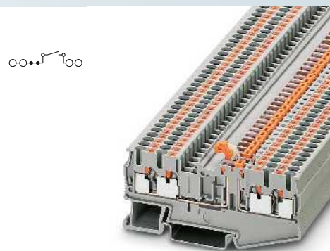
2,5 (4) mm 2 , 20 A, borne interrumpible por cuchilla, 4 conexiones
