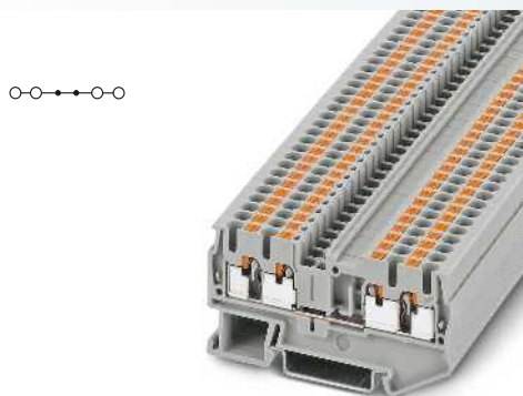
2,5 (4) mm 2 , 30 A, borne de paso, 4 conexiones
