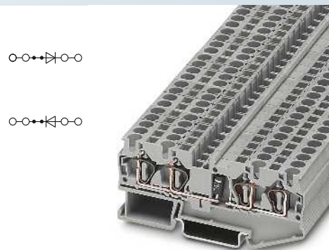
4 (6) mm 2 , 1,5 A, borne de diodos con 1N 5408, 4 conexiones
