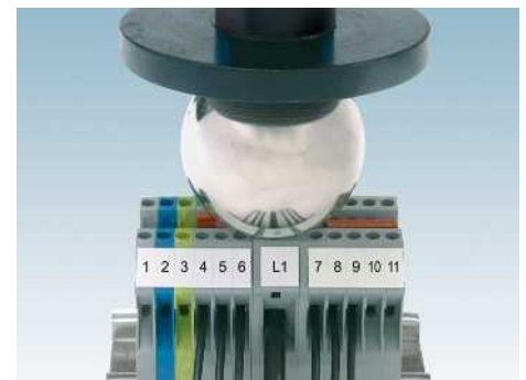
Bola de prueba Ø 50 mm
