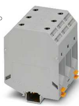
240 (240) mm 2 , 415 A, bloque de bornes
