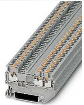
1,5 (1,5) mm 2 , 17,5 A, borne de paso, 3 conexiones
