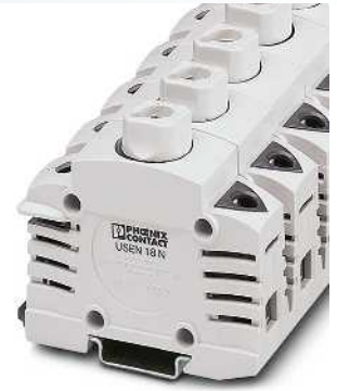
35 (35) mm 2 , 63 A, borne para fusibles para NEOZED D 02 (E18)
