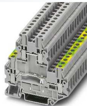
2,5 (4) mm 2 , 28 A, borne de doble piso para conductor de protección
