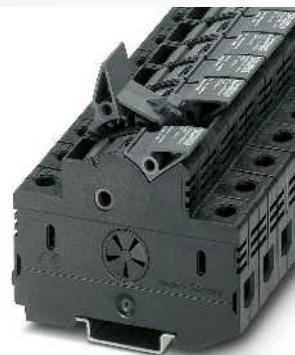
16 (25) mm 2 , 32 A, borne para fusibles con palanca para fusibles Midget 10,3 x 38 mm
