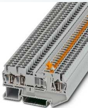
2,5 (4) mm 2 , 20 A, borne interrumpible por cuchilla, 3 conexiones
