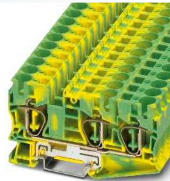
10 (16) mm 2 , 70 A, borne de tierra, 3 conexiones
