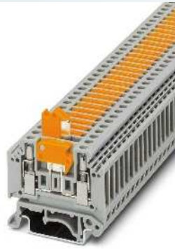
2,5 (4) mm 2 , 16 A, borne interrumpible por cuchilla con conector hembra de prueba roscado
