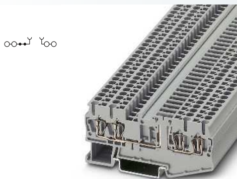
2,5 (4) mm 2 , 20 A, borne de interrupción, 4 conexiones
