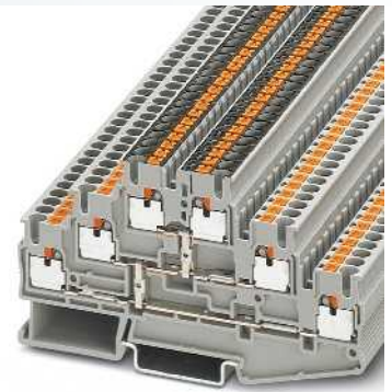
2,5 (4) mm 2 , 24 A, borne de tres pisos, pisos con unión interna
