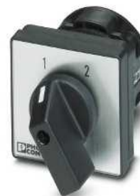
2,5 (2,5) mm 2 , 20 A, conmutador sin posición 0, con contactos galvánicos separados
