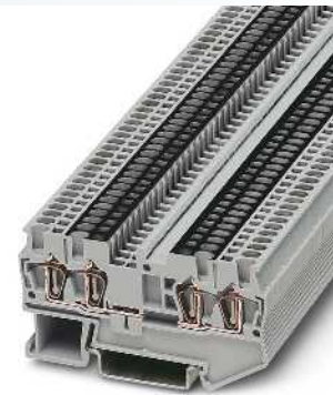
1,5 (1,5) mm 2 , 17,5 A, borne de paso, 4 conexiones, con barra colectora dividida
