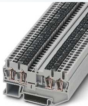
2,5 (4) mm 2 , 28 A, borne de paso, 4 conexiones, con barra colectora dividida
