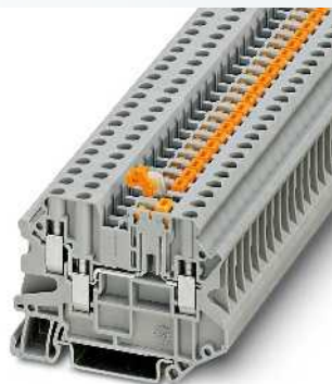
4 (6) mm 2 , 20 A, borne interrumpible por cuchilla, 3 conexiones
