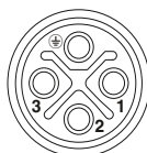
Esquema de polos del conector hembra M12, 4 polos, codificado S, vista de la cara de hembras
