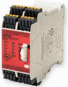
La unidad de control de seguridad de baja velocidad permite trabajar en modo de mantenimiento con la maquinaria.
