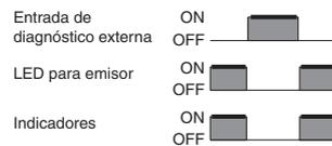
El sensor se encuentra en estado normal si la salida de control cambia cuando la entrada externa de autodiagnóstico se pone en ON u OFF. El sensor no se encuentra en estado normal si la salida de control no cambia cuando la entrada externa de autodiagnóstico se pone en ON u OFF.
