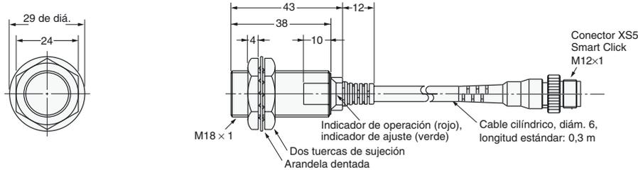
Modelos con cable y conector M12
