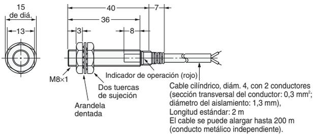
Cable cilíndrico, diám. 4, con 2 conductores (sección transversal del conductor: 0,3 mm<sup>2</sup>; diámetro del aislamiento: 1,3 mm), Longitud estándar: 2 m
