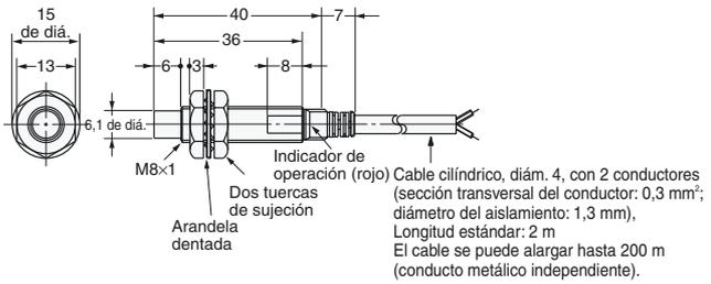
Cable cilíndrico, diám. 4, con 2 conductores (sección transversal del conductor: 0,3 mm<sup>2</sup>; diámetro del aislamiento: 1,3 mm), Longitud estándar: 2 m
