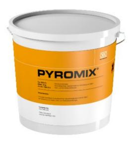
Mortero para crear el cable y la combinación de aislamiento sólido en paredes y techos. Adecuado para el bombeo, presionando y para la instalación manual. La adición de aprox. 3 litros de agua a 10 kg de mortero seco, produce alrededor de 10 litros de viable compuesto.
