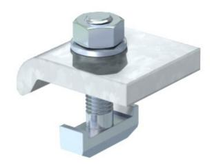
Elija la sujeción ángulo de acuerdo con el espesor de la brida. La sujeción ángulo se utiliza en conjunción con el perfil de los rieles de la ranura de ancho 22 mm (por ejemplo, tipo de CPS 5).
