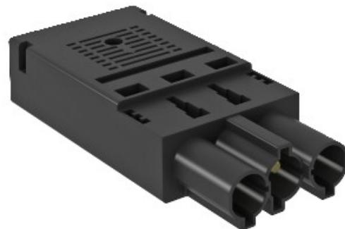
Conecotor de la parte, de 3 pinos, tipo GST18i con poder de primavera de conexión para cables rígidos de 1,5-2,5 mm<sup>2</sup>, de un solo cable y por ultrasonidos, soldadas de alambres finos cables de 1,5 mm<sup>2</sup> con el final de las mangas, se desmonta, con alivio de tensión, puede ser terminado in situ, 250 V, de 16 A.
