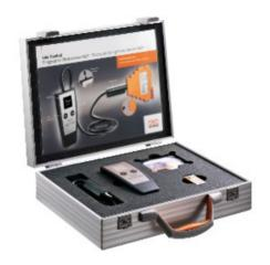
OBO Vida de Control permite el control de la función de la MDP rayo barreras. El rayo barreras pueden ser examinada mientras instalado. La vida de Control no tendrá ninguna influencia sobre la señal de medición.
