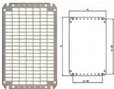
**Descripción:** Simplifica la instalación y el montaje de equipo. Taladros rectangulares de 26x11 mm para conseguir la posición de montaje mediante tuercas enjauladas. Las tuercas se pueden mover dentro del taladro rectangular. Ajustable en profundidad con el accesorio AMG.
