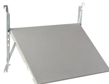
**Descripción:** Se monta directamente sobre el marco de la puerta y proporciona una superficie estable para planos, documentación, ordenador o aparatos de medida. El pupitre es abatible y fijado en el interior del marco de la puerta. Ofrece un sistema de posicionado automático en ángulos de 55, 70° y 90°. El pupitre DDK 800 se puede montar en puertas de 1000 mm de ancho utilizando el accesorio DCP1002.
