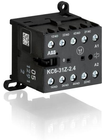
La RC6-31Z mini contactor relé es un compacto de 4 polos del contactor relé con terminales de tornillo. Son ideales para aplicaciones donde la fiabilidad es una necesidad y el espacio está en un premio. Mini contactores relés se utilizan en residencial buldings, edificios comerciales e industriales para la conmutación de las señales de control de hasta 3 a / 400 V (AC-15). Otras características son el silencioso y hum-libre de la bobina y un conmutador de indicación de posición.
