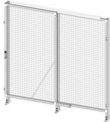
Rápida de la Guardia E slidingdoor sección con 44x44/44x88mm perfiles. Incluyendo los componentes de los perfiles, malla soldada, policarbonato, suspensión de ruedas, rectores de los componentes de piso, soportes y netlocks. La altura Total de 2200m m, anchura de la puerta 1100 mm c-c de los perfiles.
