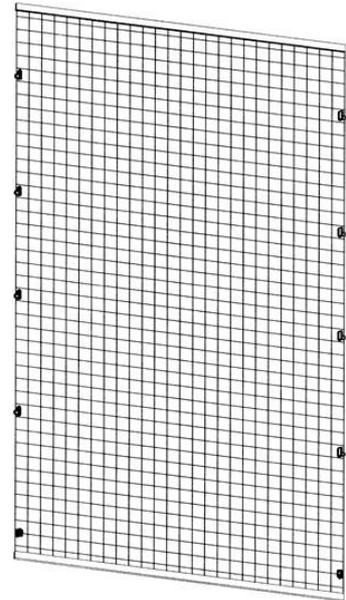
Rápida de la Guardia de el Correo de la sección sin perfiles. Incluyendo componentes, policarbonato 1074x2016mm, netlocks y protección de borde. La altura Total de 2200m m, ancho 1100 mm c-c perfiles
