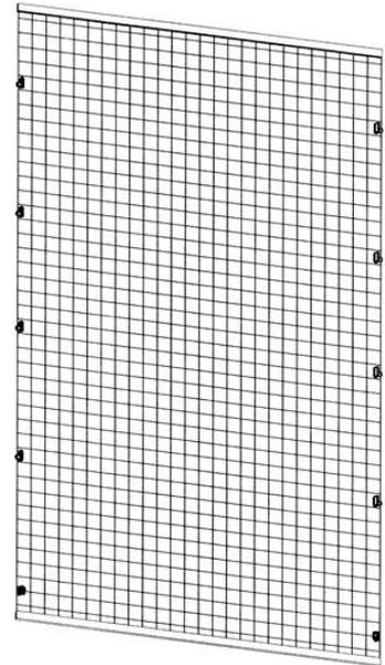
Rápida de la Guardia de el Correo de la sección sin perfiles. Incluyendo los componentes de la malla soldada 1074x2016mm, netlocks y protección de borde. La altura Total de 2200m m, ancho 1100 mm c-c de los perfiles.
