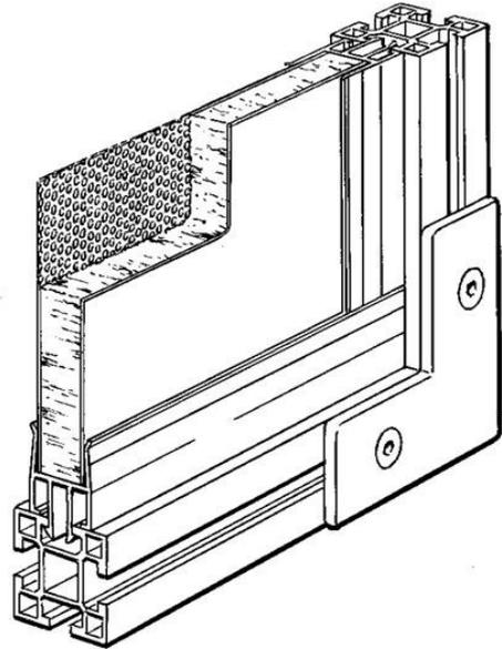
Montaje de perfil de 25mm de absorción de sonido de los paneles. Natural anodizado de Aluminio, longitud 2000mm
