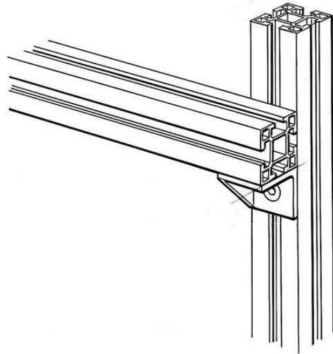
Pequeño ángulo de soporte en aluminio. Dimensión 40x40x40mm. con un contador hundido agujero, pre-ensamblados.
