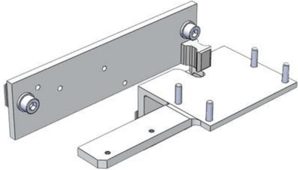
La fijación de las placas de Dalton y Eden adaptado a ABB Jokab vallado de Seguridad del sistema.
