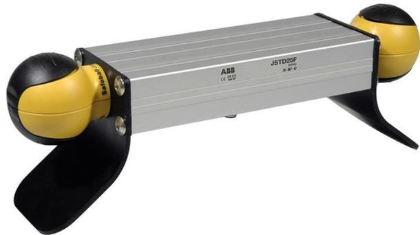
Con las dos manos dispositivo con JSTD1-B Safeballs. Botones laterales montadas en un 44x88 de aluminio extruido perfil diseñado para la dos-mano de aplicaciones. Pre-cableado para un M12 de 8 pines conector con protectores de bridas de la safeballs. Alto nivel de seguridad se puede lograr cuando se utiliza en conjunción con un JSBR4 relé de seguridad o Plutón PLC de Seguridad.
