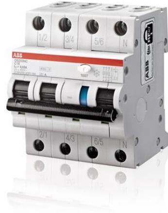
DS203NC es un 3P+N residual interruptor de circuito de corriente con protección contra sobrecorriente (RCBO) en cuatro módulos para la protección contra corrientes de cortocircuito, sobrecarga, falla a tierra de las corrientes, los contactos indirectos, la protección adicional contra contactos directos (30 mA versiones).
