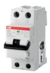
DS201 serie RCBO es una 1P+N en dos módulos de dispositivo para la protección de los usuarios finales de una sola fase de circuitos contra sobrecargas y corrientes de cortocircuito; la protección contra los efectos de alterna sinusoidal de la tierra de las corrientes de falla; la protección contra los contactos indirectos y protección adicional contra contactos directos (con sensibilidad = 30 mA).
