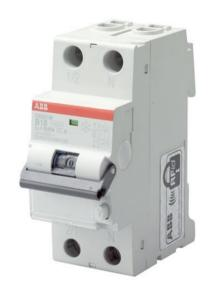
DS201 serie RCBO es una 1P+N en dos módulos de dispositivo para la protección de los usuarios finales de una sola fase de circuitos contra sobrecargas y corrientes de cortocircuito, protección contra los efectos de la sinusoidal continua y alterna pulsante de la tierra de las corrientes de falla; la protección contra los contactos indirectos y protección adicional contra contactos directos (con sensibilidad = 30 mA).
