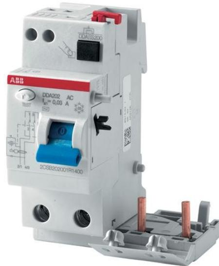
El RCD bloque DDA200 de la serie es adecuado para la asamblea con Interruptores magnetotérmicos y diferenciales de la serie S200. Asegura la protección contra los efectos de alterna sinusoidal de la tierra de las corrientes de falla, la protección contra indirects contactos y protección adicional contra directo (con una sensibilidad = 30 mA) contactos. Aplicaciones: residencial, comercial, industrial.
