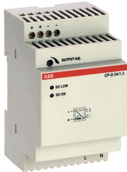
El CP-D 24/1.3 es una fuente de alimentación de la CP-D rango. La principal fuente de alimentación conmutada ofrece una amplia gama de entrada de 90 a 264 V de CA y 120-375 V DC nominal voltaje de entrada de 100 a 240 V de CA. La potencia de salida nominal es de 30 W, corriente de salida nominal es de 1,3 a a Una tensión de salida de 24 V DC. El voltaje de salida es ajustable dentro de un rango de 24 a 28 V DC. La fuente de alimentación proporciona una U/I característica de salida.
