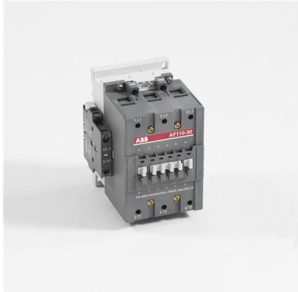
3-fase de Contactor adecuado para la conmutación de los Condensadores de la aplicación. Máximo permisible de corriente de pico 100 veces la nominal de la corriente RMS. Opera con una tensión de control, las versiones de 24V-690 V
