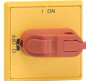
Selector de tipo palanca. Indicación I-O y ON-OFF, para el diámetro del eje de 6 mm, puerta de perforación de 22.5 mm. IP 54 asas, candado con un candado con una fianza de diámetro 5...6.3 mm, NEMA 1, rojo-amarillo, OT16...125F
