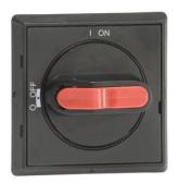
Selector de tipo palanca. Indicación I-O y ON-OFF. No se separa del eje es necesario. Candado con max. 3 candados, IP 65, distancia del agujero 36/48 mm, NEMA 1, 3R, 12, negro, OT16...125FT
