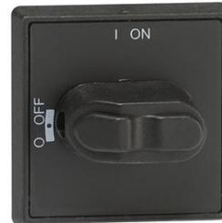
Selector de tipo palanca, la Indicación I-O y ON-OFF, para el diámetro del eje de 6 mm, puerta de perforación de 22.5 mm. IP 54 de la manija de la puerta, de enclavamiento en posición, NEMA 1, negro, OT16...80F
