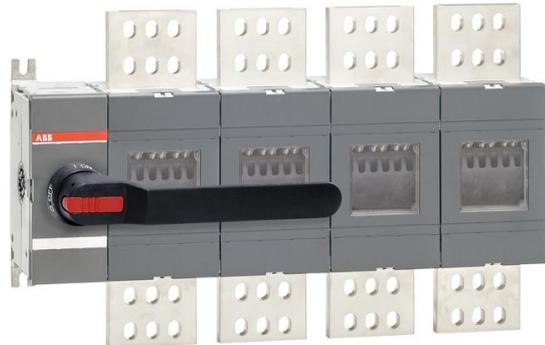
Incluyendo terminal de tornillo kit, un negro de encendido-APAGADO EN el mango de plástico OHB200J12P y el eje OXP12x280 como estándar. El mango es IP65 protegidas, de candado en la posición de salida y con enclavamiento de puerta en la posición. El eje es ajustable en un rango de profundidades de instalación.
