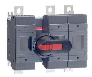
Incluyendo terminal de tornillo kit, un negro de encendido-APAGADO EN el mango de plástico y eje estándar. El mango es IP65 protegidas, de candado en la posición de salida y con enclavamiento de puerta en la posición. El eje es ajustable en un rango de profundidades de instalación.
