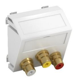
Мультимедийное сопровождение с тремя разъемы RCA для аудио/видео, наклонным отводом кабеля, с пультом маркировки, три гнезда cinch (RCA) с соединением под пайку, маркировка цвета желтый / красный / белый. Опорная пластина с фиксатором крепления, подходящий для горизонтальной и вертикальной установки в системе среды.
