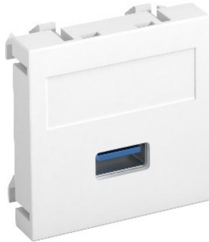
Поддержка мультимедиа с один USB 3.0 разъем, прямой выход кабеля, с пультом маркировки, USB 3.0 Тип разъема с винтовым соединением. Опорная пластина с фиксатором крепления, подходящий для горизонтальной и вертикальной установки в системе среды.
