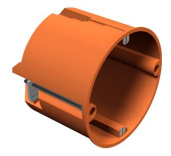
Полость стены аксессуары/розетки. Размеры согласно DIN 49073-1, для плиты толщиной 7-35 мм. Стандартная комбинация расстояние 71 мм, возможность для постоянного подключения подключения поддержка сочетания аксессуар розетки и подключение розеток, 8 секционных отверстия для кабели марок NYM, кабели и трубы диаметром 20 мм, монтажные коробки также можно использовать в качестве подключение розетки к VDE 0606-1 с двойной болты крепления и винт-на крышке, степень защиты IP20.
