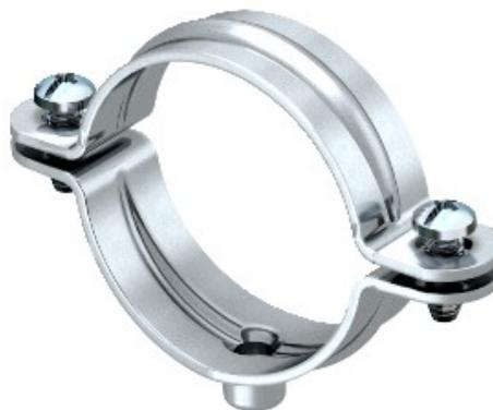
Крепления с винтом в клипы распорка. Клипы прокладка и винт-распорка клипы доступны в различных материалах: в легированной стали марки v2a, в electrogalvanised, горячее цинкование стали или алюминия. Крепление может происходить с болтом связей или Рыболов якоря и Спринт винты. В зависимости от конструкции, зажимы могут быть "выстрел" с помощью болт-огневые средства или гвоздь устройство.
