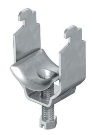
Подходит для всех профиль С рельсов с шлицем шириной 11-12 мм; Внутренняя высота не менее 6,5 мм и не менее ясно, 18.5 mm внутренний Ширина; металлические желоба сильно закругленными краями со всех сторон, так что нет риска повреждения кабеля.
