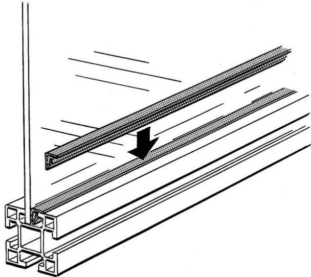
Заполнение крепления ленты черного пластика ABS. Л=732 мм для 4 мм панелей.
