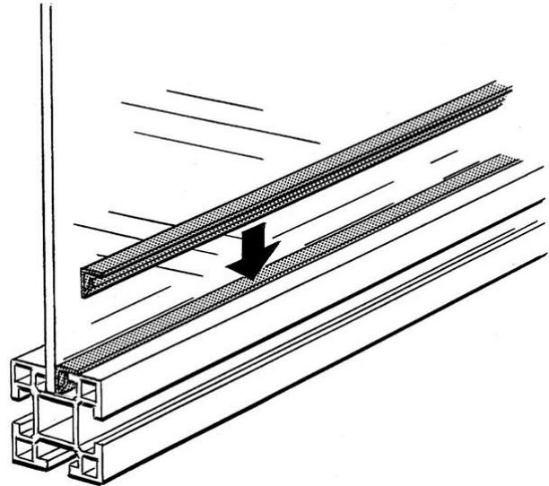
Заполнение крепления ленты черного пластика ABS. Л=2000 мм для 4 мм панелей.
