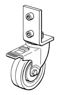
Опорное колесо с блокировкой и тормоза, в том числе и угловой кронштейн. Колеса диаметром 75мм, высота 97мм. Максимальная нагрузка 60кг
