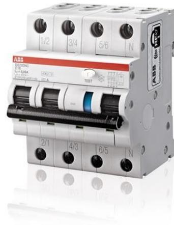
DS203NC это 3P+N выключатель остаточного тока с защитой от сверхтоков (АВДТ) в четырех модулей для защиты от токов короткого замыкания, перегрузки, токов замыкания на землю, косвенные контакты, дополнительная защита от прямого контакта (30 мА версий).
